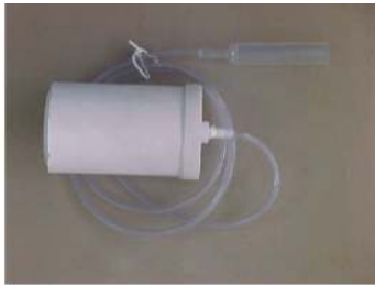
Figura 3.1- Irrigas de 25 kPa com cuba para o teste de imersão.
