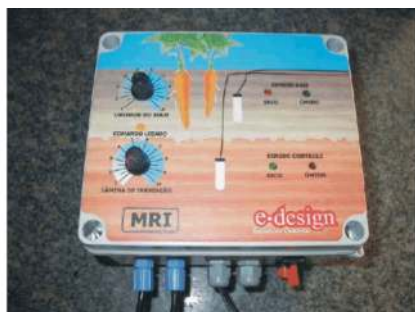
Figura 17.4- MRI um tensiostato a gás para manejo de irrigação com sensores Irrigas, fabricado Hidrosense. Foto: cortesia Hidrosense.
