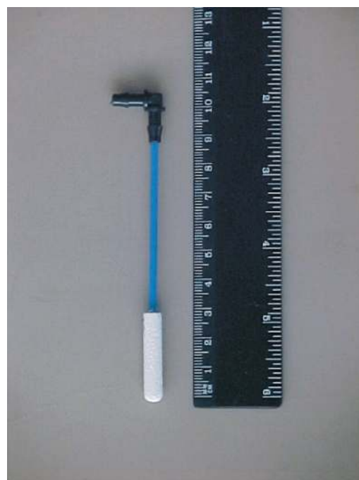
Figura 3.8- Sensor Irrigas com cápsula porosa mini da Hidrosense utilizado para manejo de irrigação de mudas em tubetes.
