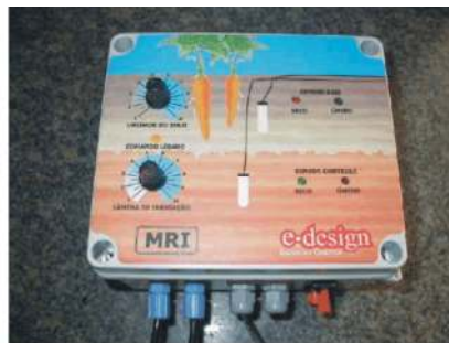
Figura 18.11- MRI um tipo de tensiômetro a gás para manejo de irrigação fabricado pela Hidrosense. Foto: cortesia Hidrosense.
