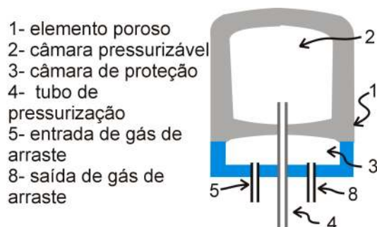
Figura 14.14- Irrigas bifacial com todos os tubos fixadas na câmara de proteção, para facilitar a inserção do sensor em amostras de solo ou de planta.
