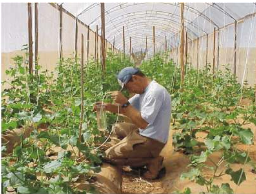
Figura 4.2- Leitura de sensores Irrigas com auxílio de um reservatório de água transparente.
