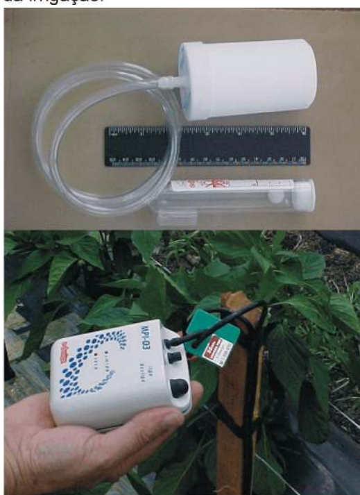
Figura 16.2- Acima: um sensor Irrigas com cuba transparente para verificar se o solo está com tensão de água maior ou menor que a tensão crítica do Irrigas pelo teste de imersão em um frasco com água. Abaixo: sensores Irrigas sendo lidos com um aparelho MPI-03.
