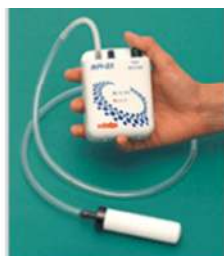
Figura 18.10- MPI-03 um instrumento para ler sensores Irrigas. Foto: cortesia Hidrosense.
