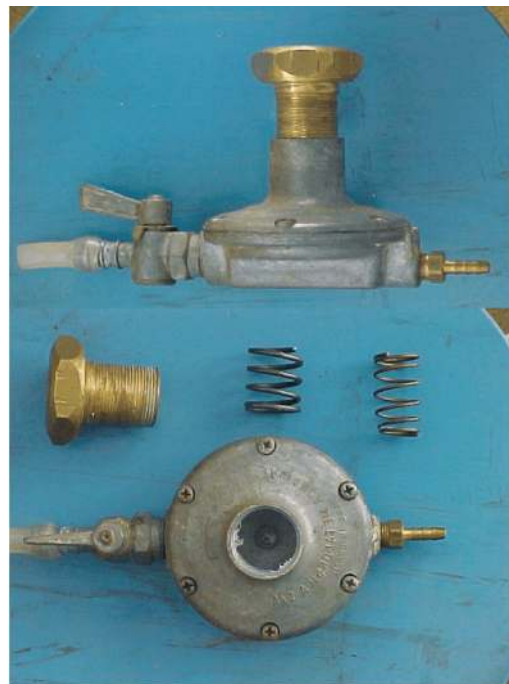
Figura 10.6- Detalhes de uma válvula para controle de pressão montada no topo para evidenciar o parafuso e as molas utilizadas.
