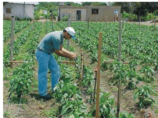
Figura 16.3- Estação de controle de irrigação com sensores Irrigas instalados em duas profundidades.
