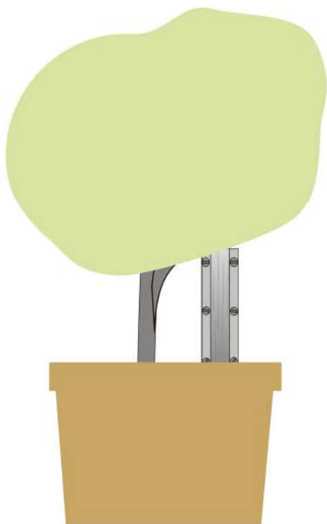
Figura 3.16- Vaso com um visualizador de umidade de placa ranhurada sem o tubo de Irrigas.
