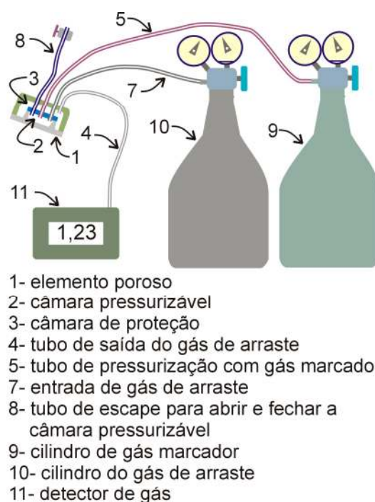
Figura 14.13- Esquema de um tensiômetro a gás montado com um sensor Irrigas bifacial para medir tensão de água, alimentado por gás marcador (9), sob pressão ajustável, e no qual o gás permeado para a câmara de proteção (3) é carreado para o detector de gás (11), por um fluxo ajustado do gás de arraste (10).
